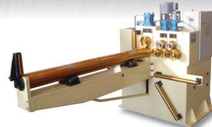
**DESBOBINADORES PRE-ENDIREITADOR PARA FIO-MÁQUINA**
